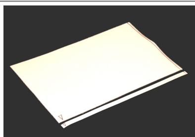
**Delrin** in Platten und Streifen. Die Fließrichtung ist durch einen Pfeil markiert.
