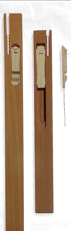
**Holzspringer, Typ Cristofori in Standardmaßen** mit dem Dämpferschlitz links wie auf der Abbildung. Der Springer ist fertig bearbeitet. Die Achse und die obere Regulierschraube sind montiert. Die fertige Zunge wird lose mitgeliefert und kann einfach auf die Achse des Springers aufgesteckt werden. Bitte separat bestellen:
